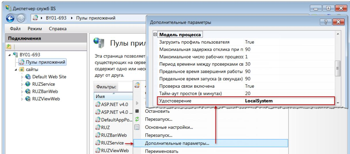
Рис. 17. Настройка дополнительных параметров для web-службы
