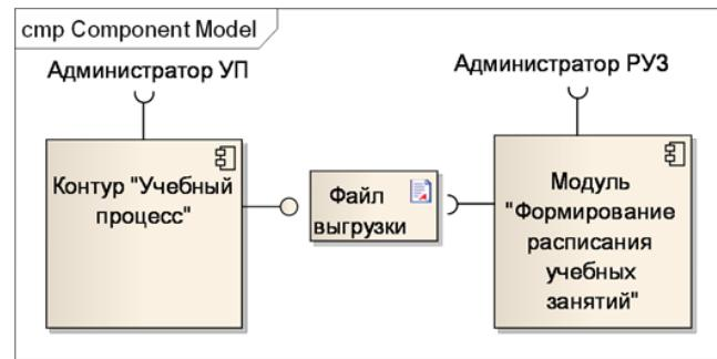
Рис. 32. Схема взаимодействия системы автоматизации учебного процесса и РУЗ
